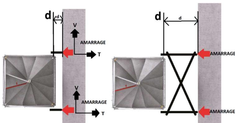
Lorsque le « d » est supérieur à 20 cm, il peut s'avérer de renforcer le système d'amarrage par un contreventement.
