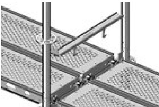
**7** Planchers en acier galvanisé à chaud, percés de trous pour les rendre antidérapants. Ils s'accrochent dans les supports-planchers.
