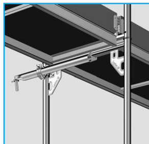
Fixation avec collier d'ancrage pour cadre Euro.
